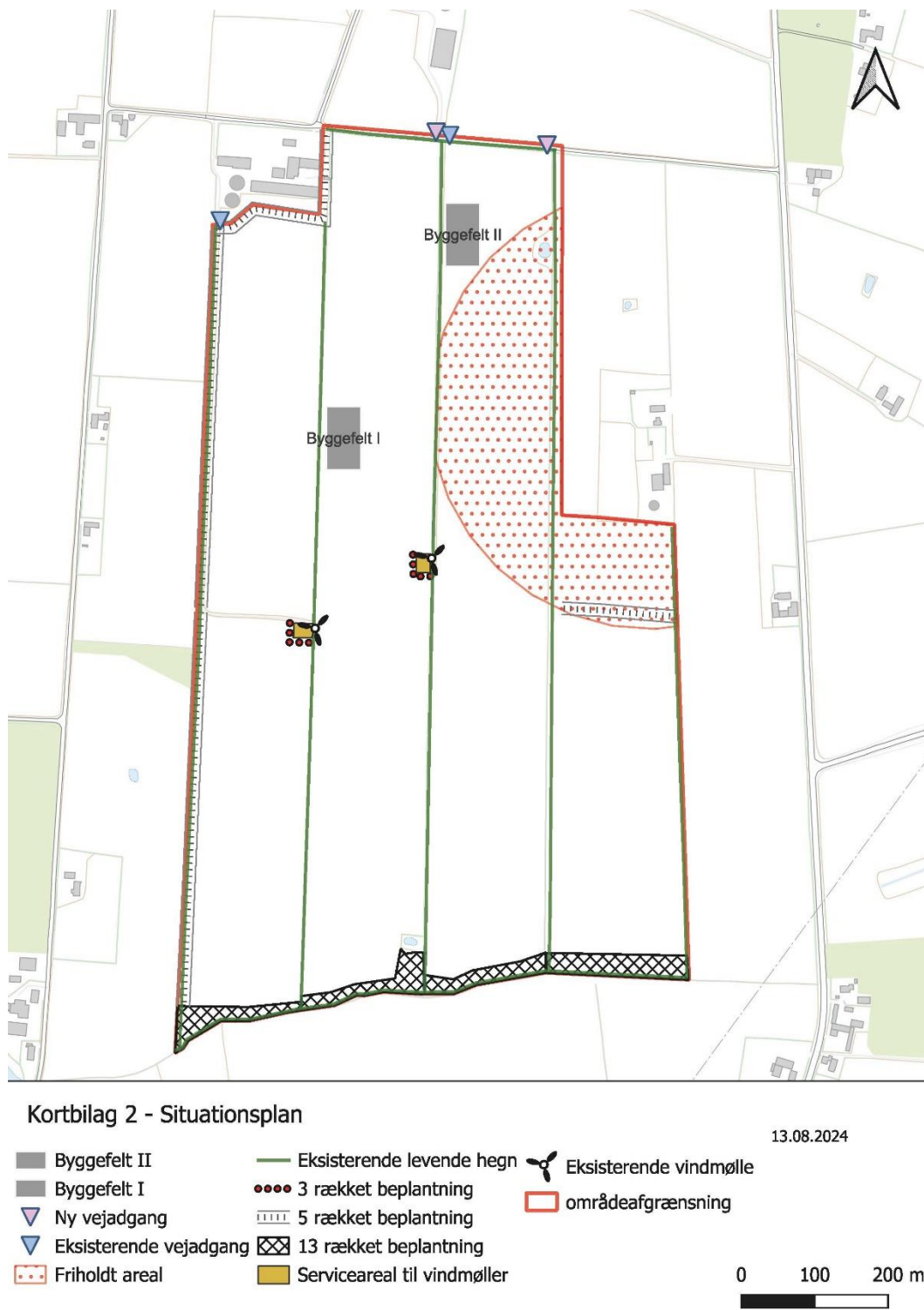
Figur 3-4. Lokalplankort med disponering af solcelleanlægget.
