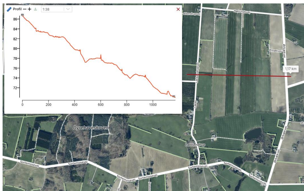
Figur 11-3 Længdeprofil over eksisterende terrænforhold – Venstre side i længdeprofil er vest og højre side af længdeprofil er øst
